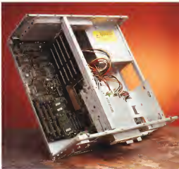
Una vista generale dell'interno che mostra la distribuzione delle memorie. Si nota le «masa» intercambiabile con slot VESA e ISA.
